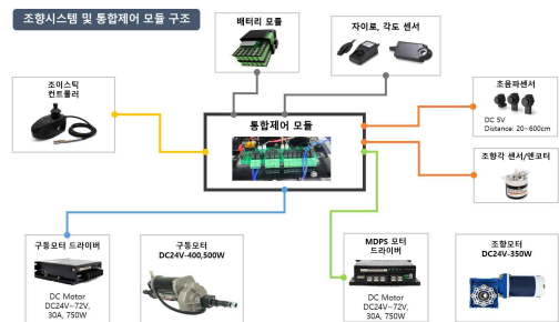
<그림 4> 조향 시스템 및 통합제어 모듈 구조
