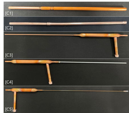
그림 3. 파이프 형상(T형, P형)과 필러 링에 따른 클래스 구성 예시. Fig. 3. Examples of class configurations according to pipe shapes (T-type, P-type) and filler rings.
