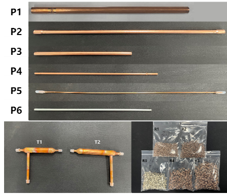
그림 2. 파이프 형상(T형, P형)과 필러 링들(R1-R5). Fig. 2. Pipe shapes (T-type, P-type) and filler rings (R1-R5).
